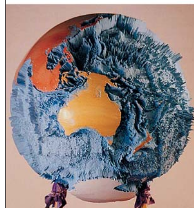
Пластиковые глобусы Земли. Рельеф суши (вверху) показан с преувеличением вертикального масштаба в 250 раз, рельеф морского дна — в 150 раз. Масштаб 1:28 000 000, диаметр — 46 см на ур.м. [12].
